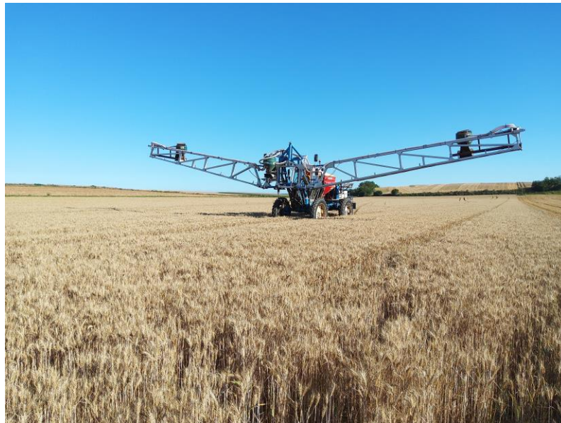
Système de semis à la volée avec des rampes (FDC77)
