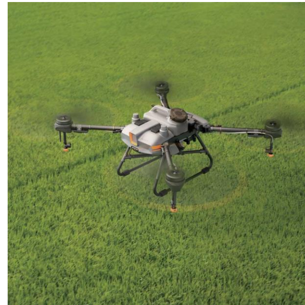
Système de semis à la volée avec un drone agricole (FICIF)
